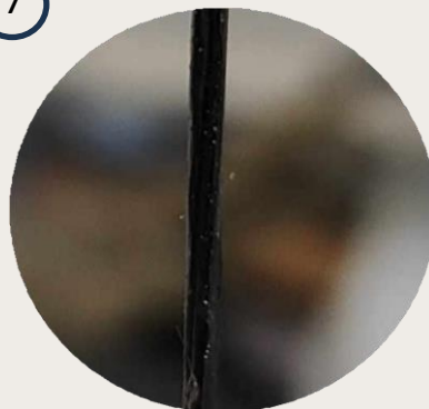
4 piliers réalisés sous forme de tresses résinées avec des mèches de carbone issues du tissu pour la reprise de charge
