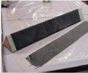
Drapage des couches et moulage au contact
