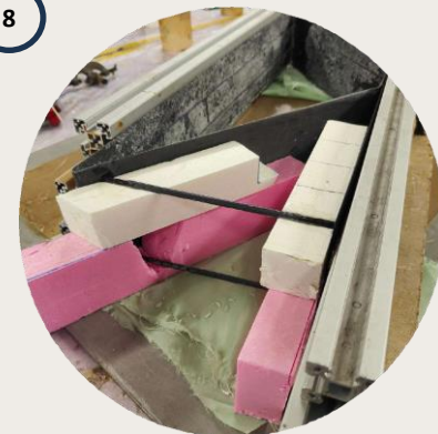
Assemblage des piliers sur le pont avec de la résine
