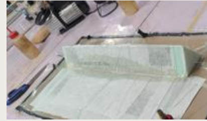
Création de la base en polystyrène et du tablier
