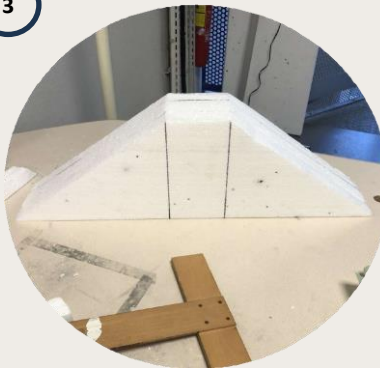
Drapage des couches et moulage au contact
