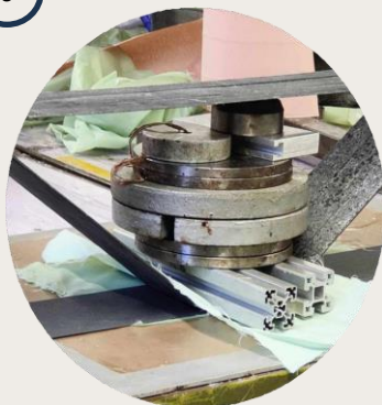
Assemblage des deux parties par collage avec la résine
