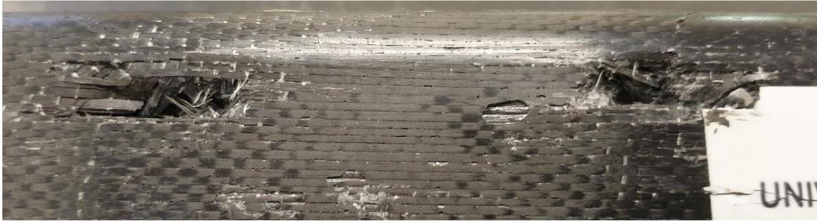
Perforation du tablier puis rupture au cisaillement d'une équerre de renfort
