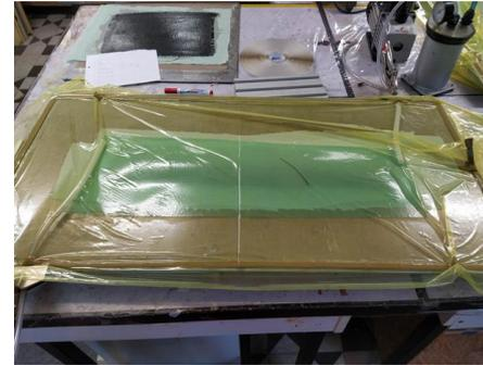
Installation à l'aide de mousses de 5 couches de pré-impregné
