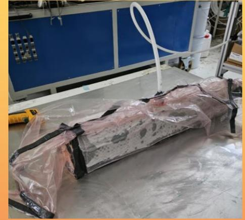
La mise sous vide a été réalisée sur le côté car une empreinte apparaissait sur le prototype
