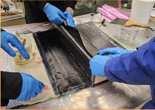
Le drapage a d'abord été réalisé en dessous puis sur la partie supérieure
